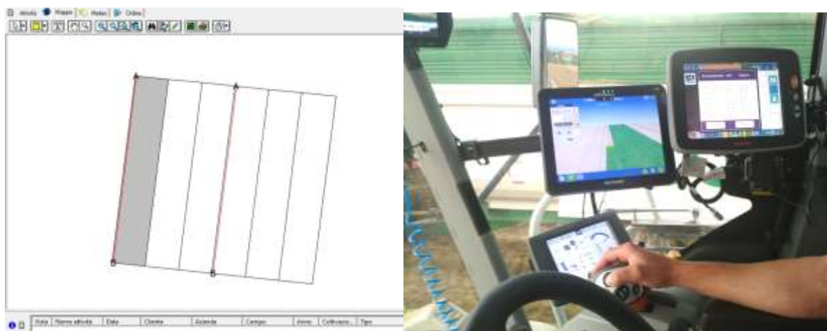
Figura 4-2. Esempio di definizione delle linee di transito e la successiva visualizzazione sul computer di bordo del trattore.
